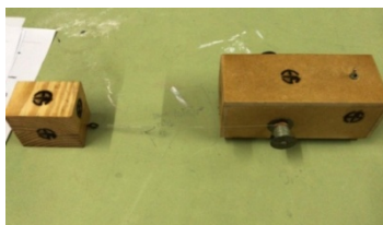
FIGURA 6. Dispositivo de 2 velocidades (malacate) diseñado por alumnos de la EIS.
