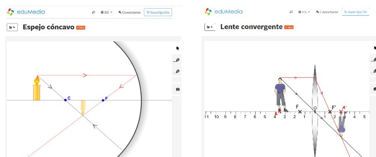
FIGURA 2. Ejemplos de simuladores para observar cambios en tamaño y posición de la imagen de un objeto al reflejarse la luz en un espejo (izquierda) o refractarse en una lente (derecha). Edumedia-science.
