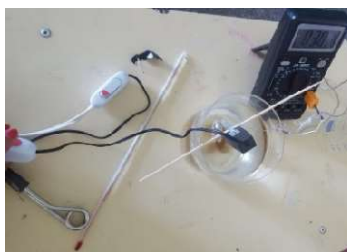
FIGURA 1. Calentador eléctrico colocado dentro de vaso de precipitado, el cual contiene agua y su temperatura medida por un multímetro.
